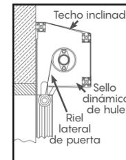
Montaje sobre muro dentro o fuera de un edificio
