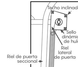
Montaje atrás de puerta seccional de andén
